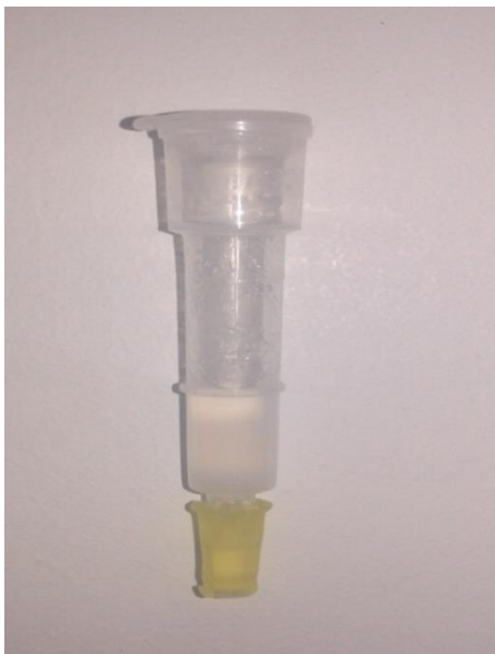
Рисунок 41. Внешний вид хроматографической колонки с твердофазным иммуносорбентом
